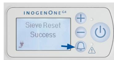
13. Premere una volta il pulsante di avviso e lo schermo visualizzerà "sieve reset success" (ripristino filtri completato).
