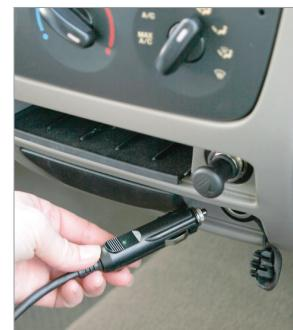
4. Controleer het scherm van het toestel om te bevestigen dat een externe voedingskabel is verbonden. Er verschijnt een pictogram van een batterij met een bliksemschicht of een wisselstroomstekker op het scherm, die aangeeft dat een dat een externe voeding is aangesloten en juist werkt.
