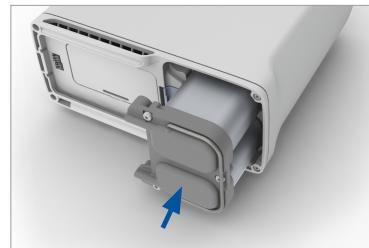
10. Spingere il gruppo colonnine nel dispositivo in modo che le colonnine si inseriscano completamente nel concentratore Inogen One® G4. Il pulsante di blocco caricato a molla deve ritornare completamente alla posizione chiusa.
