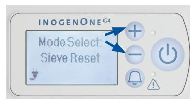
12. Premere e tenere premuti i pulsanti più (+) e meno (-) per 5 secondi Lo schermo visualizzerà il messaggio "sieve reset" (ripristino dei filtri). Rilasciare il pulsante una volta che il messaggio viene visualizzato sullo schermo.
