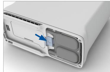
6. Während Sie die Taste aufhalten, die Säuleneinheit aus dem Gerät nehmen, indem Sie den Säulengriff ziehen.
