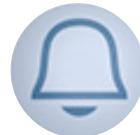
Modo de alerta para la detección de la respiración. Cuando este modo está activado y no se detecta respiración durante 60 segundos, el Inogen One® G4 emite una alerta mediante señales sonoras y visibles para indicar que no se detecta la respiración.
