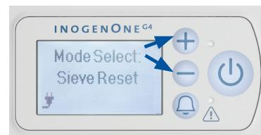
12. Houd de plus (+)- en min (-)-knoppen gedurende 5 seconden ingedrukt. Op het scherm zal het bericht "zeef opnieuw instellen" (sieve reset) te zien zijn. Laat de knop los als het bericht op het scherm wordt weergegeven.
