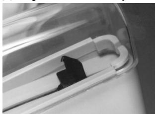
Убедитесь, что выключатель насоса находится в положении ВЫКЛ и что черная пластина под защитным устройством шприца достигла ограничения хода. Если черная пластина не достигла ограничения хода, проверните большую круглую ручку по часовой стрелке до упора.
