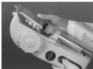
Вставьте предварительно заполненный шприц с уже подсоединенной трубкой в защитное устройство шприца градуировкой вверх, плунжером вперед. Убедитесь, что диск люэровского разъема трубки плотно сидит в носовой части насоса.
