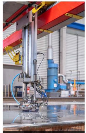
ULTRASONIC TESTING EQUIPMENT AT NOBELCLAD'S LIEBENSCHEID, GERMANY PRODUCTION FACILITY
