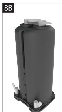
9. A/B. Włożyć kolumny do koncentratora Inogen One® G5. Nie pozostawiać końców kolumn odsłoniętych. Kolumny powinny zostać włożone do koncentratora Inogen One® G5 jak tylko osłony przeciwpłytkowe zostaną zdjęte.
