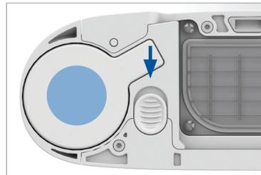
7. Mantendo o botão aberto, deslize a coluna (tubo de metal) para fora, segurando com a outra mão na superfície de alumínio exposta.
