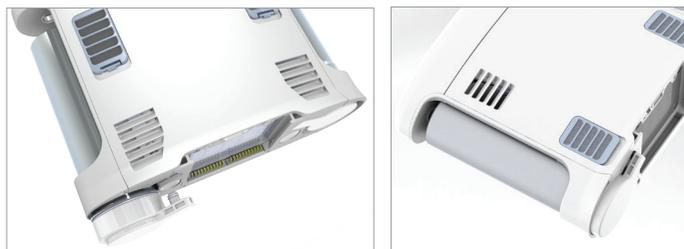
12. Empurre a coluna (tubo de metal) para dentro do aparelho de modo a que a coluna (tubo de metal) fique completamente assente no concentrador Inogen One® G3. O botão de fecho accionado por mola deve regressar completamente à posição fechada.
